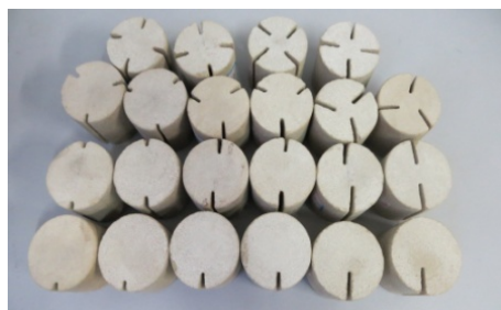
图 1 含非贯通裂隙的砂岩试样
