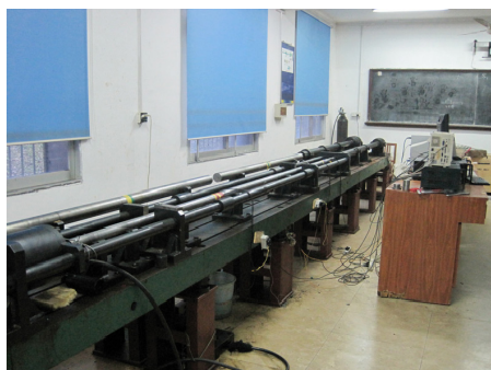
图 2 SHPB 试验装置及试验系统
